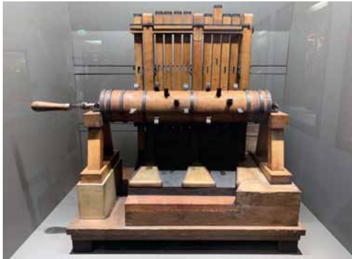
Modèle d'un bocard, exposé au Musées des Arts et Métiers de Paris. Le bocard, actionné par la force hydraulique, sert à concasser le minerai de fer qui sera fondu dans le haut fourneau. Les marteaux se relèvent et s'abaissent en rythme grâce à l'arbre à cames. Photo : Armand Logelin-Simon.
